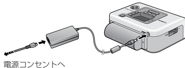
充電中は電源スイッチが橙色に点灯し、充電が完了すると消灯します。
