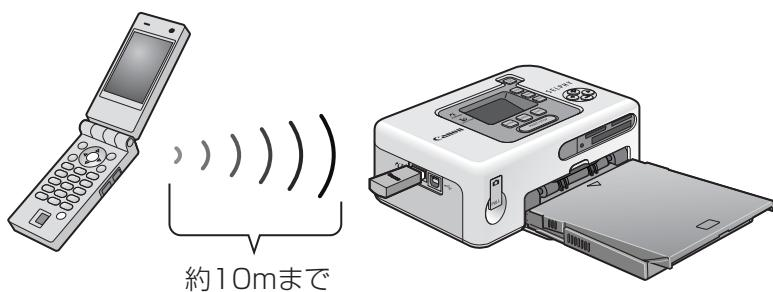
通信中は、プリンターの液晶モニターに次のような画面が表示されます。また、Bluetoothユニット BU-20 が青色に点滅します。通信中は、Bluetooth通信の接続を切断しないでください。もし、切断した場合はプリンターの電源を切ってから、送信をやり直してください。
