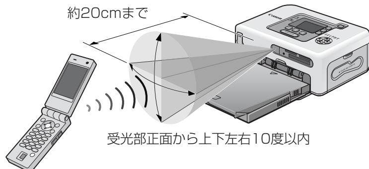
IrDAの通信可能な距離は、携帯電話の機種、環境によって変化します
