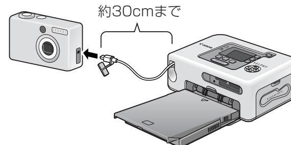
巻き取り式のUSBケーブルのコネクタの形状が、カメラと合わない場合は、カメラに付属のUSBケーブルで接続します。
